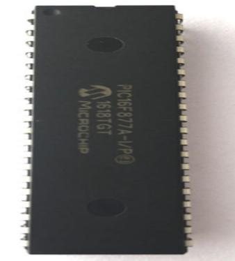
Figura 19. Encapsulado del PIC 16F877A
