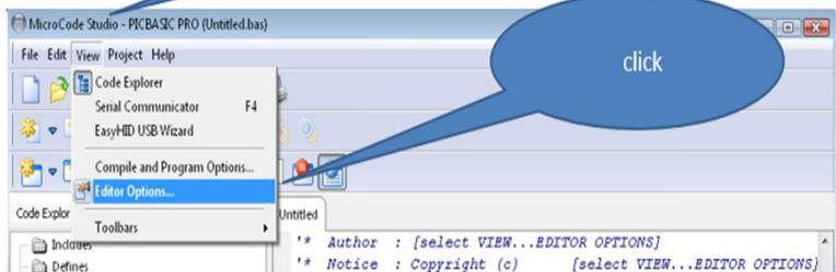
Figura 30. Configuración de IDE MicroCode Studio
